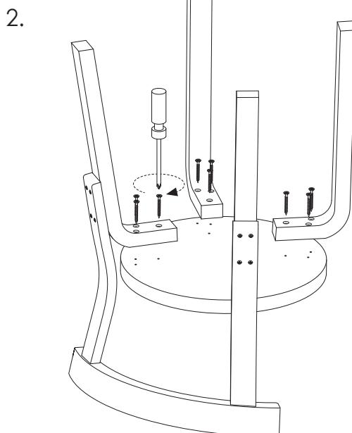
HUOM. Kiristä takajalkojen ruuvit istuimeen vasta selkänojan kiinnittämisen jälkeen.
