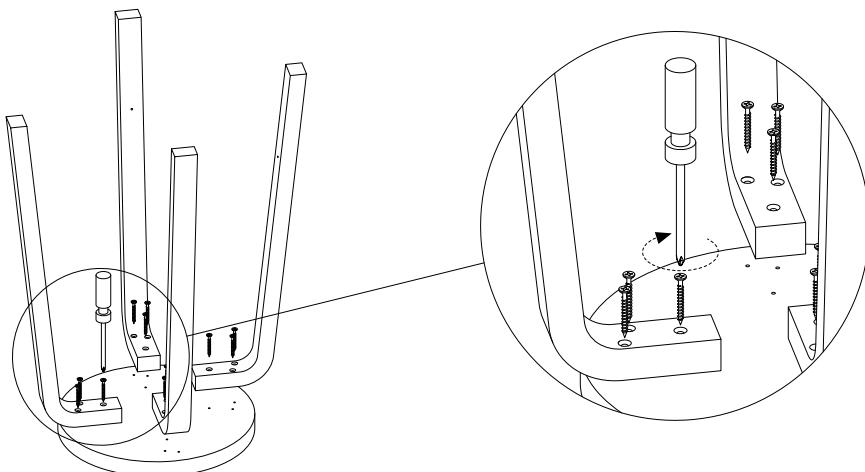
HUOM. Kiristä jalkojen ruuvit tiukasti vasta jalkarenkaan kiinnittämisen jälkeen.
